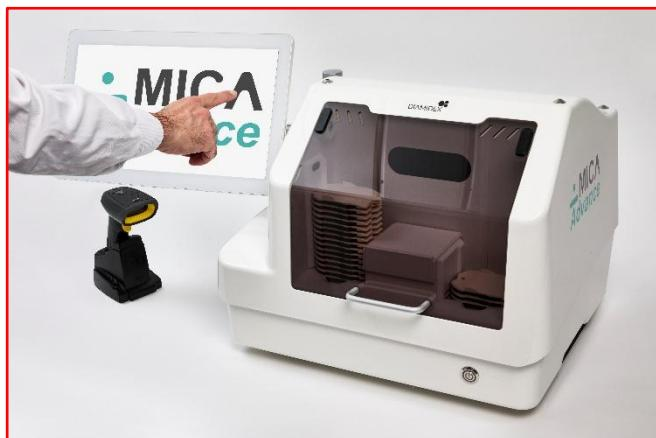
MICA Advance *Coliformi Totali* conta automaticamente le colonie di *E. coli* e Coliformi in campioni di acque potabili e in bottiglia fornendo risultati accurati in CFU/vol. filtrato dopo 10-12 ore di incubazione.
